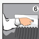
Нанесите клей зубчатым шпателем. При укладке крупноформатных, тяжеловесных плит нанесите тонкий слой клея на тыльную поверхность плитки, что улучшит контакт поверхности плитки с клеем. В этом случае расход клея увеличится. Уложите плитку в течение 30 минут после нанесения клея на поверхность. Выровняйте плитку в течение 20 минут.
