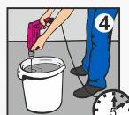
Для подготовки раствора залейте водопроводную воду комнатной температуры в чистую ёмкость из расчёта 0,29-0,32 л воды на 1 кг сухой смеси. Засыпая сухую смесь в воду, перемешивайте раствор дрелью со специальной насадкой на низких оборотах до получения однородной массы. Подождите 5 минут, после этого перемешайте вторично. Время пригодности раствора к работе не менее 30 минут.
