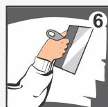
Шпатлевку БОЛАРС «Saten» нанесите стальным шпателем на основание слоем от 0,2 до 5 мм. Для получения более толстого слоя допускается шпатлевание в несколько слоев. Последующий слой нанесите после полного высыхания предыдущего, предварительно прогрунтовав поверхность грунтующими составами БОЛАРС.
