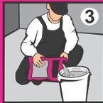
**3** Для подготовки раствора залейте водопроводную воду комнатной температуры в чистую ёмкость из расчёта 4,6 - 5,2 л воды на 1 мешок (20кг).
